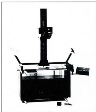
OK 102: planetario per la ripresa su microfiche e pellicola 16/35 mm in bianco/nero ed a colori. Dotato di piani di lavoro intercambiabili basculanti per libri, per libri antichi che non possono essere aperti oltre 90°, aspiranti, controilluminati, con alimentatore automatico di documenti, ecc.
